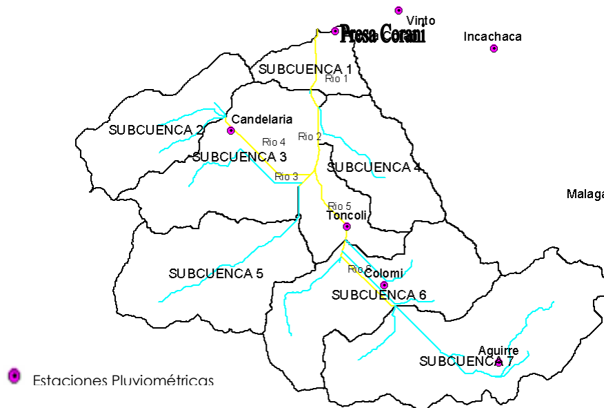
Figura N° 2.37. Cuenca vertiente al embalse de Corani, con red de drenaje principal y separación en subcuencas.
