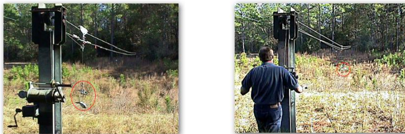
Figura 6.14. Aforo desde un cable carril
